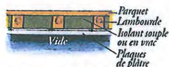
Isolation sous le plancher existant
