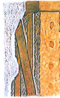
mur en pan de bois et torçis enduit à la chaux
