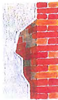
mur ancien en briques enduit au plâtre ou chaux
